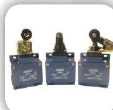
Corpo metálico com 3 entradas para cabo. 1NA+NF AC15=3A 240VCA Ip66
