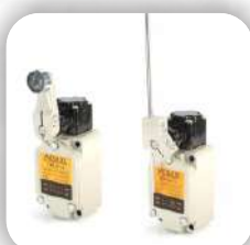
Corpo metálico 1NA+NF 5A - 250VCA Ip67 Vários atuadores disponíveis
